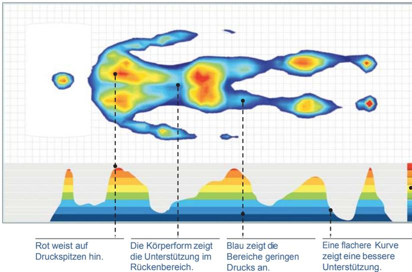
Das Bild von ComfortMap™ zeigt, wie gut eine Matratze zum jeweiligen Körper passt. Das Diagramm illustriert die Druckverteilung.
