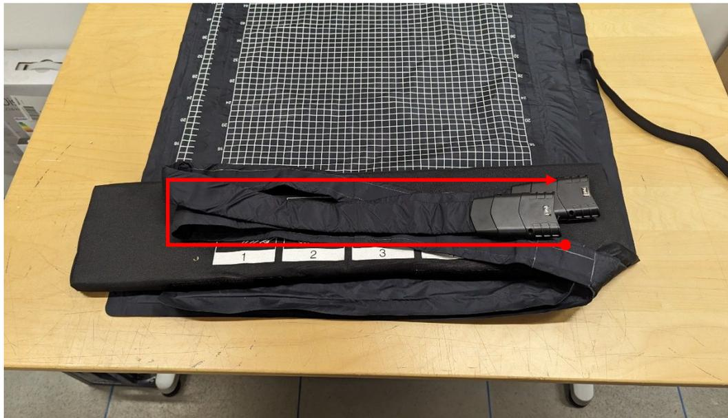
**Die Anschlusskabel der Sensormatte in einer Schleifenform auf das Kissen legen.**
