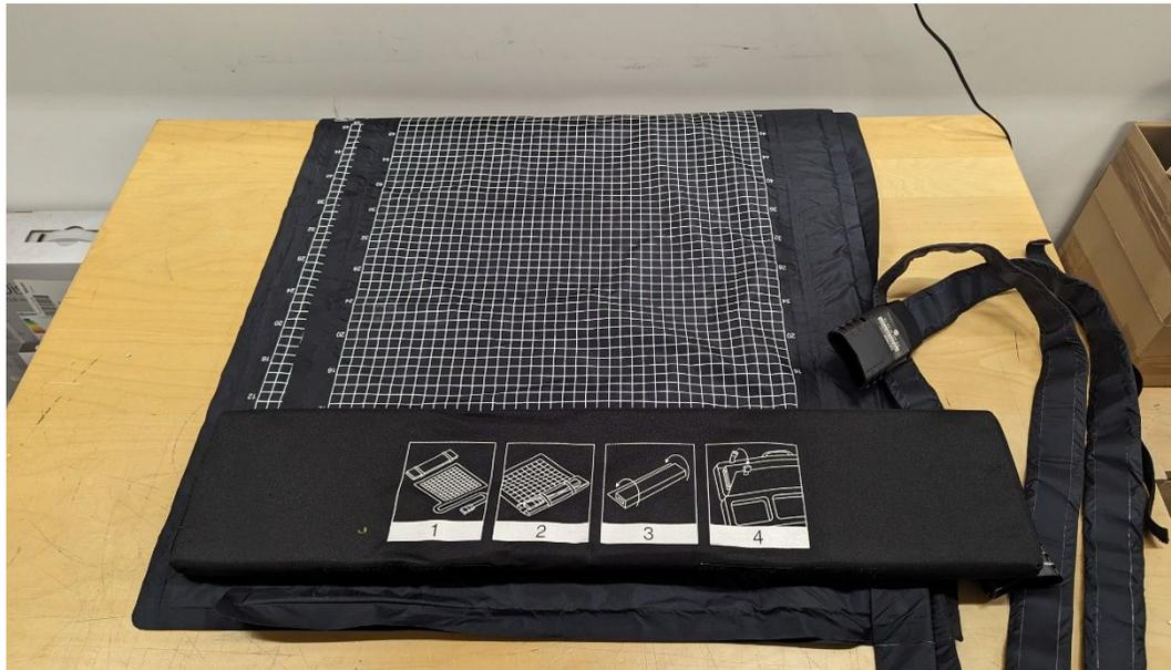
**Sensormatte mit dem Raster nach oben auf eine ebene Unterlage legen und das mitgelieferte Kissen wie abgebildet auf die Sensormatte legen.**
